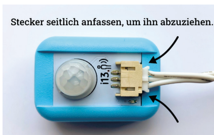
Kabel in die Buchse richtig eingeschoben
