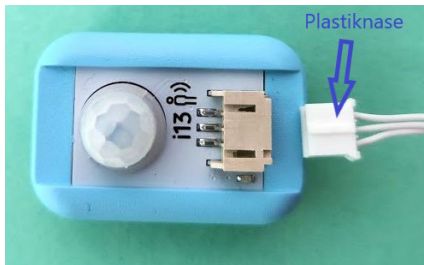
Kabel mit Plastiknase nach oben
