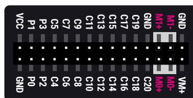
Über die **Pinleiste** können zusätzliche Motoren angeschlossen werden. Auf der Rückseite des Calliope mini findest du die Bezeichnungen der einzelnen Pins.
