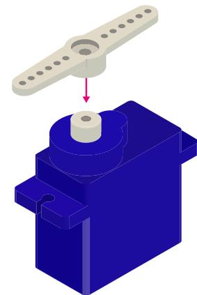
Hinweis: Bei der Programmierung wird die Position des 180° Servomotors über die Gradzahl bestimmt. Beim 360° Servomotor steuerst du die Geschwindigkeit in Prozent (-100% bis 100%).
